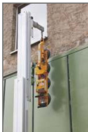
LMX 500 - mit Lastenhaken und Glassauger für die Montage von Glasscheiben
