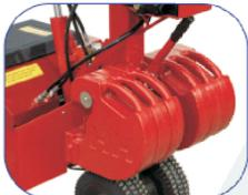
„Es ist eine gute Idee, dass das Gegengewicht in sechs kleinere Gewichte aufgeteilt ist. Auf diese Weise können wir die Maschine immer so justieren, dass sie so leicht wie möglich wird.“
