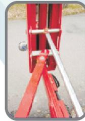
Das Frontsystem lässt sich mit Hilfe des Verschiebearmes 50 mm nach jeder Seite verschieben
