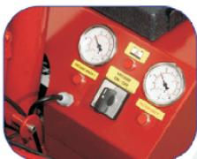
„Es gibt uns Sicherheit dass eine 2Kreis Vakuumsaugung vorhanden ist. Das erhöht die Sicherheit. Besonders bei ganz großen Fenstern.“
