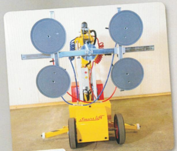
*Das Vakuumsystem des Lifts ist in zwei separate Kreise unterteilt, für höchste Sicherheit. Hier sind Vakuumkreise mit blauen bzw. roten Vakuumschläuchen zu sehen.*
