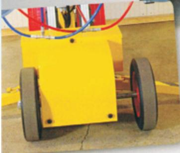
Der SL 380 Midi ist bis zu 100 mm seitenverschiebbar zur Feinjustierung beim Fenstereinbau.
