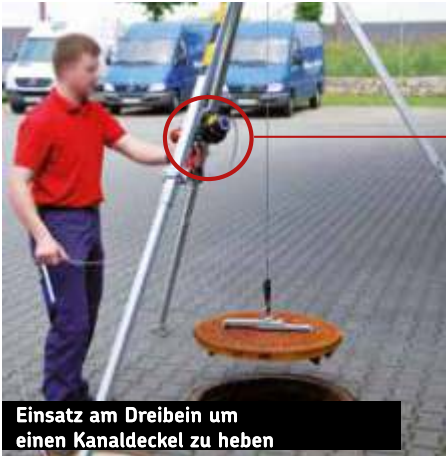
Befestigung am Dreibein durch Adapterplatte mit Anschlagring
