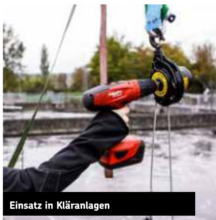
Befestigung am Dreibein durch Adapterplatte mit Anschlagring
