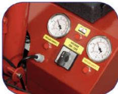
„Es gibt uns Sicherheit dass eine 2Kreis Vakuumansaugung vorhanden ist. Das erhöht die Sicherheit. Besonders bei ganz großen Fenstern.“
