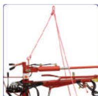
Eine leichte aber trotzdem tragfähige Kette ermöglicht das Anheben des GlasLifts zwischen den Stockwerken
