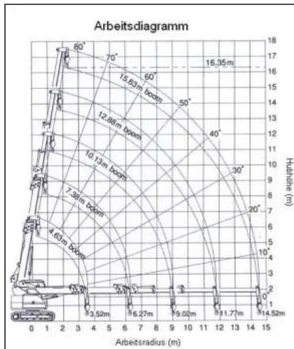
Die verfahrbaren Lasten sind für Auslegerlängen bis zu 10,13 m möglich.
